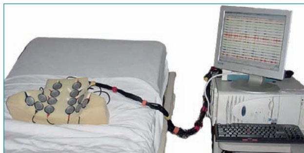
Figure 16. Système de capture des sons, développé par Stethographics, sous forme de coussin équipé de microphones permettant de capter simultanément les sons pulmonaires ou cardiaques, en différents points sur la face postérieure du thorax [20].
