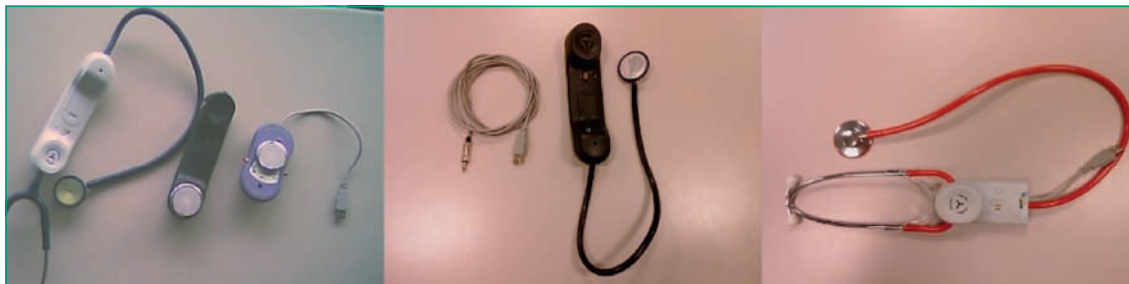
Figure 24. Prototypes de stéthoscopes électroniques développés par la Société Alcatel-Lucent (données de M. R. Gass) [5].
